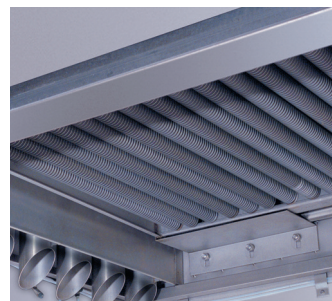
Das Kühlregister einer Bastra-Intensiv-Kühlanlage.
